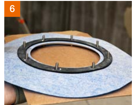
6 De zelfgemaakte lijmfrens is klaar om aan te brengen.
